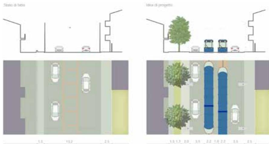
Sopra e a sinistra: alcune sezioni tipo del prolungamento della linea del metrobus punta ad integrare la viabilità carrabile e tramviaria minimizzando l'ingombro stradale, nel rispetto delle norme di sicurezza e del codice stradale.
