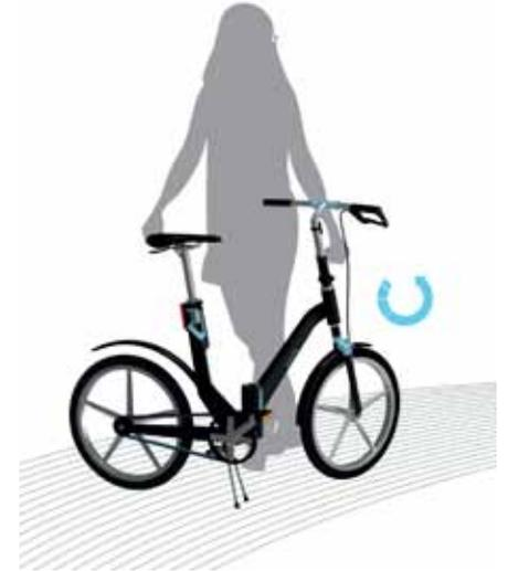
In questa pagina esempi di configurazione chiusa della bicicletta DEMI. Lo studio prevede (sopra) un sistema di chiusura per rotazione, di trasporto come trolley (a sinistra) e di appoggio con cavalletto (sotto). Tutto questo per facilitare la movimentazione e ridurre l'ingombro del mezzo in spazi ridotti come il treno o altri mezzi pubblici.
