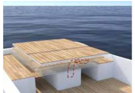
Sopra: La copertura si compatta scorrendo sulla struttura in tubolare perimetrale; la pedana di accesso anteriore si solleva diventando un vano che può essere adibito a differenti funzioni; il piano dogato posteriore si trasforma in un comodo tavolo per sei persone attraverso un sistema a pantografo.
